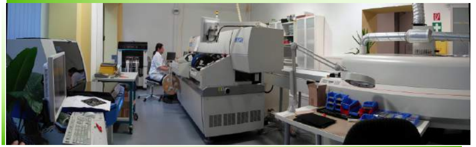
La production ZIMO: deux machines de placement, four de brasage reflow etc...
